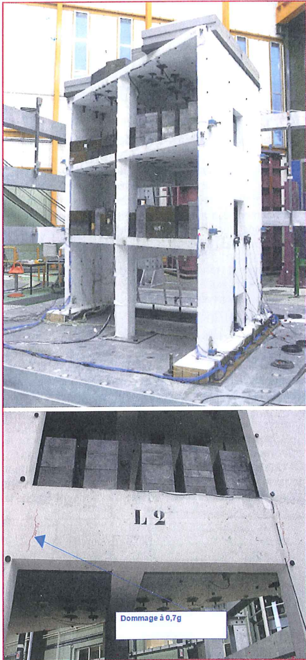
Fig. 8 – La maquette SMART-2008 sur la table vibrante Azalée du CEA Saclay, en haut, et dommage observé pour une accélération de 0,7g, en bas. (La maquette est dimensionnée à 0,2 g selon la pratique nucléaire).
