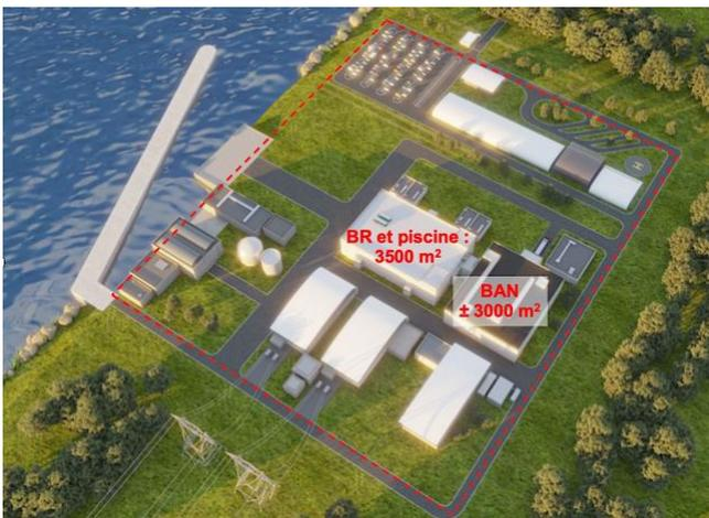
Schéma de gauche [EDF SEPTEN], encadré en rouge : l'îlot nucléaire d'un REP 900 MWe (environ 5200 m<sup>2</sup>). A droite, représentation photoréaliste [Sfen] du projet de SMR avec repérés en rouge le Bâtiment réacteurs (BR) et la piscine des combustibles (3500 m<sup>2</sup>) ainsi que le BAN (Bâtiment des auxiliaires nucléaires) d'environ 3000 m<sup>2</sup>. La superficie de l'ensemble des installations serait de l'ordre de 9 ha.
