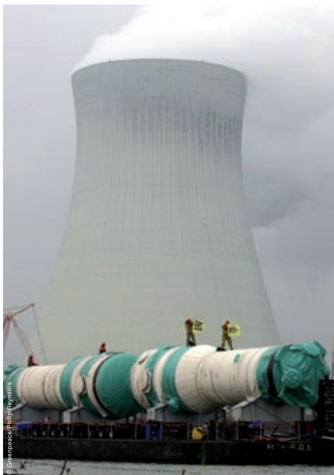
Nouveau générateur de vapeur pour la centrale nucléaire de Doel.
